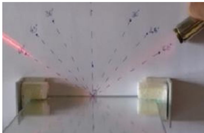
Figura 21: OBSERVAÇÃO ÂNGULO DE REFLEXÃO E INCIDÊNCIA (AUTORIA PRÓPRIA, 2015)
