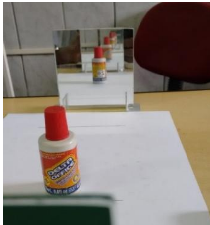
Figura 30: FORMAÇÃO DE INFINITAS IMAGENS ATRAVÉS DE ESPELHOS ACOPLADOS (AUTORIA PRÓPRIA, 2015)
