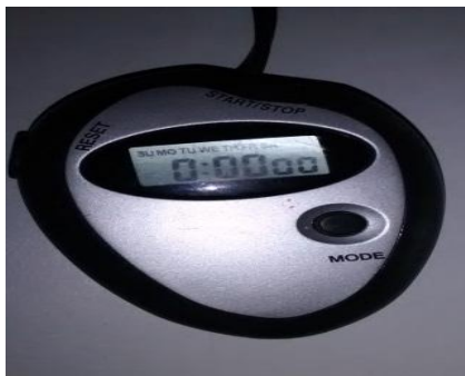
Figura 1(b). Cronômetro utilizado para aferir o tempo de queda da esfera. Fonte: Própria.
