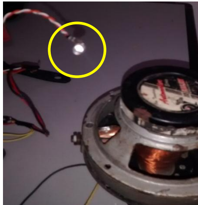
Figura 20. Terminais de conexão com a LED. Fonte: Própria.
