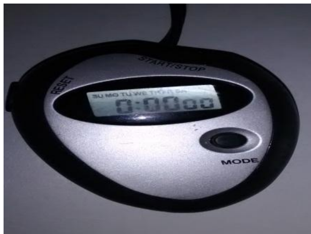
Figura 5. Cronômetro zerado, pronto para aferir o tempo de queda da esfera. Fonte: Própria.
