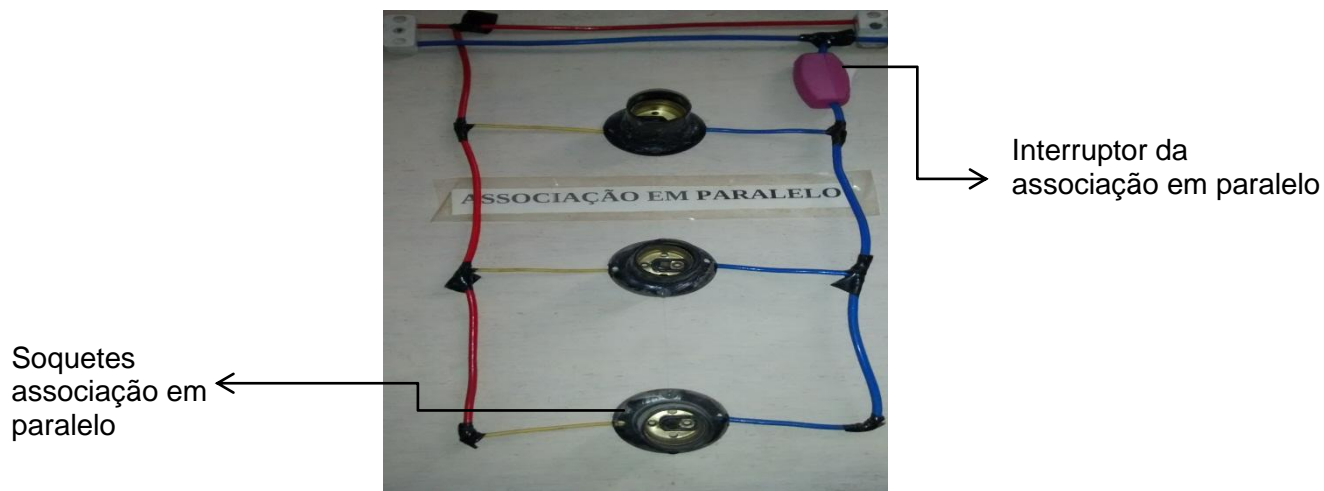
Figura 15. Lâmpadas associadas em paralelo. Fonte: Própria.
