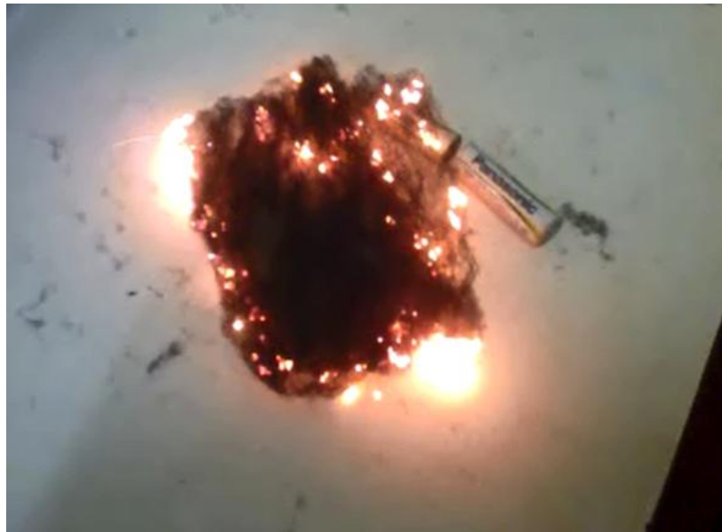
Figura 14 – Observação do experimento alternativo: Efeito Joule.
