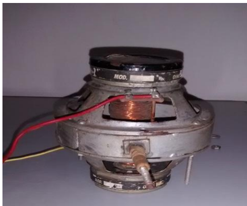
Figura 17(a). Projeto indução magnética completamente montado. Fonte: Própria.
