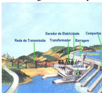
Figura 16 – Esquema de funcionamento de uma hidroelétrica
