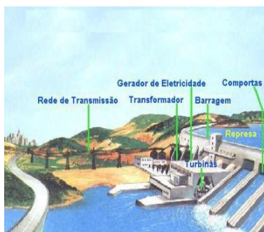
Figura 2 – Esquema de funcionamento de uma hidroelétrica
