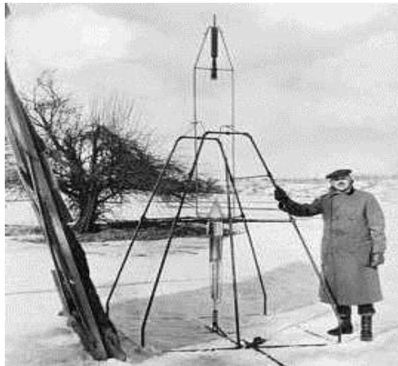
Figura 21: Goddard e o seu prim eiro foguete de com bustível líquido
