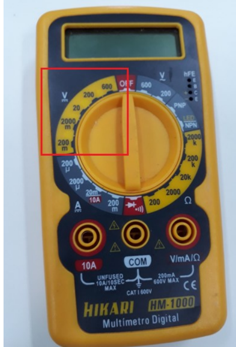
Figura 2: Escolha de escala para medida de tensão
