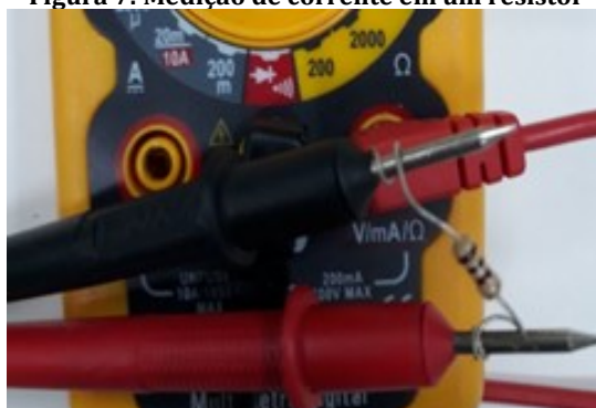
Figura 7: Medição de corrente em um resistor
