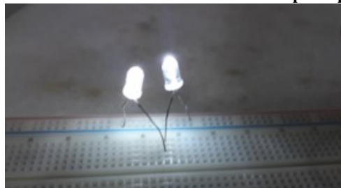
Figura 24: LED's em série em um circuito numa placa protoboard
