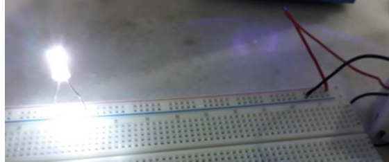
Figura 23: Conexão de um LED à fonte em uma placa protoboard
