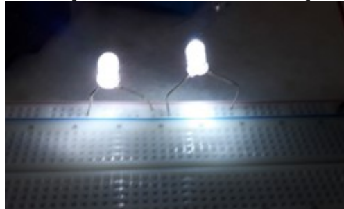
Figura 25: LED's em paralelo em um circuito numa placa protoboard
