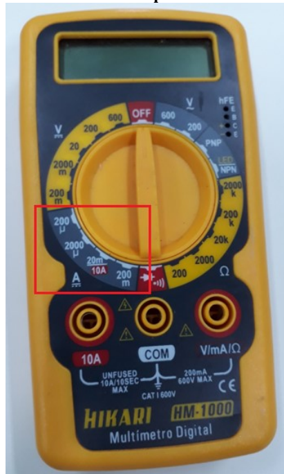
Figura 4: Escolha da escala para medida de correntes
