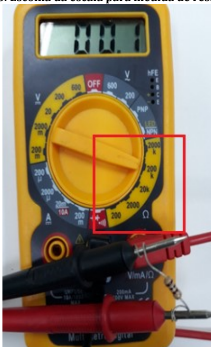
Figura 6: Escolha da escala para medida de resistências
