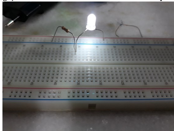
Figura 26: Ligação em série de LED e resistor de 1k\Omega numa placa protoboard
