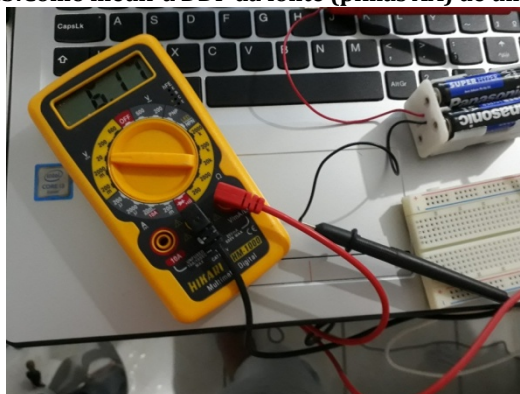
Figura 13: Como medir a DDP da fonte (pilhas AA) de um circuito
