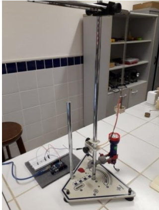
Figura 21– (a) Aparato experimental completo; (b) Em destaque o circuito e o pêndulo simples; (c) zona de interação entre a massa oscilante e o LDR;
