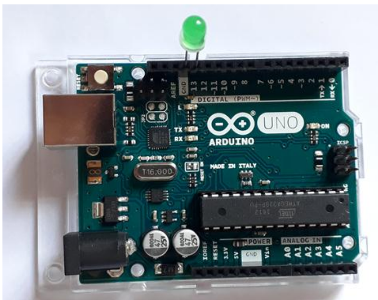
Figura 9 - LED inserido no pino 13 e o GND (autoria própria)
