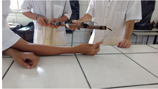
Figura 21 – Dois detectores de metais montados pelos alunos.
