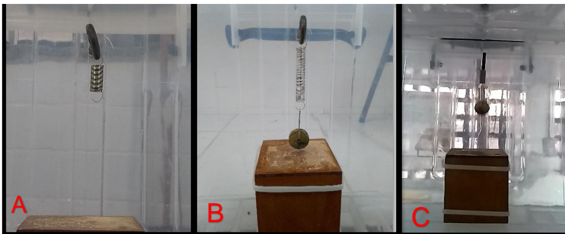
Figura 5.9: A) Mola na posição original, B) Mola distendida pela massa, C) Mola em microgravidade.
