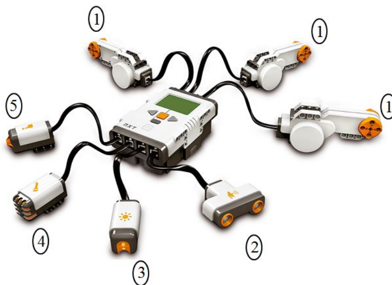
Figura 2.4: Bloco LEGO NXT conectado com seus servo motores e sensores
