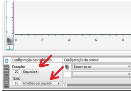
Figura B.10: Tela do software MINDSTORMS EV3 edição para professor, ajustando as configurações das unidades.
