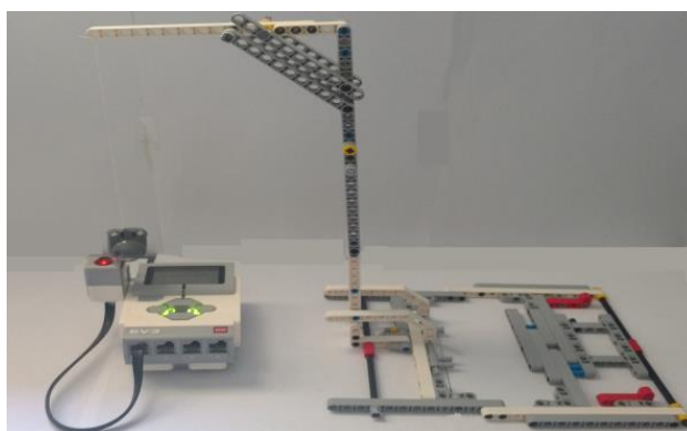
Figura B.8: Exemplo de montagem para estrutura do pêndulo.
