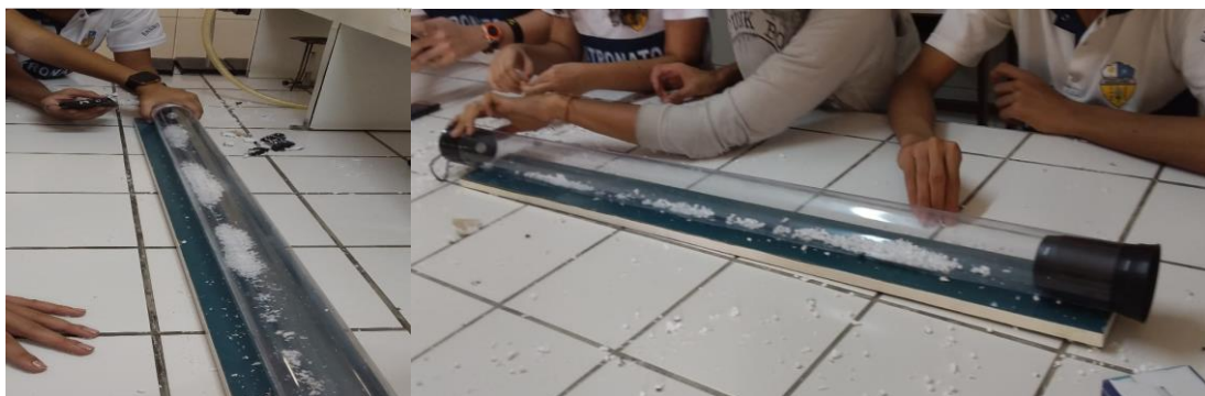
Figura17: Figura apresenta uma fotografia do tubo já montado em uso pelos alunos. Nota-se a o acumulo das bolinhas de isopor onde ficam os nós da onda estacionária.
