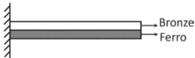
Figura 1: Representação de uma lâmina bimetálica de ferro e bronze a temperatura ambiente.
