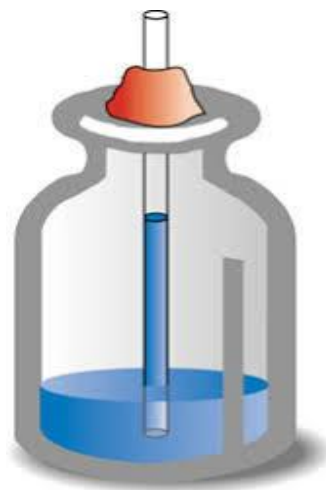
Figura 1: Representação de um Termoscópio caseiro.
