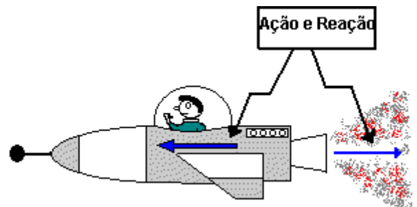
Figura 2: O jatinho empurra o ar para trás com o motor e o ar empurra o jatinho para frente como reação.
