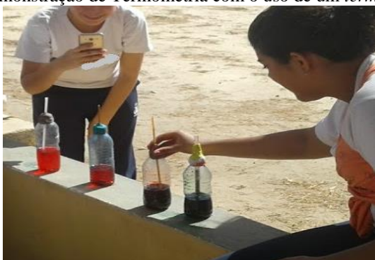
Figura 4.1: Demonstração de Termometria com o uso de um termômetro caseiro .
