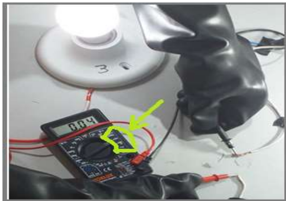
Figura 7 - Pontas de provas associado em série para medição de corrente elétrica alternada de baixa escala.
