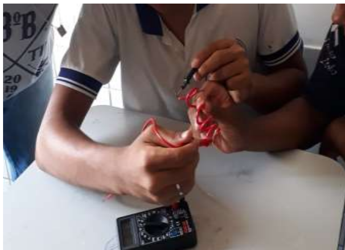
Figura 12: Aluno demonstrando como aferir medição de resistência elétrica de um fio condutor.
