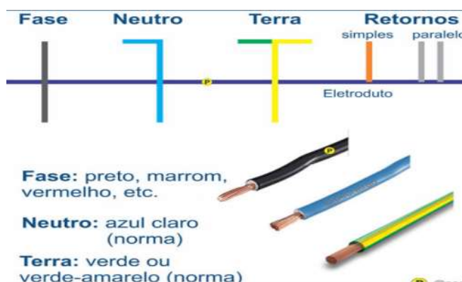
Figura 18 - Simbologias padrão das cores dos fios em um circuito.
