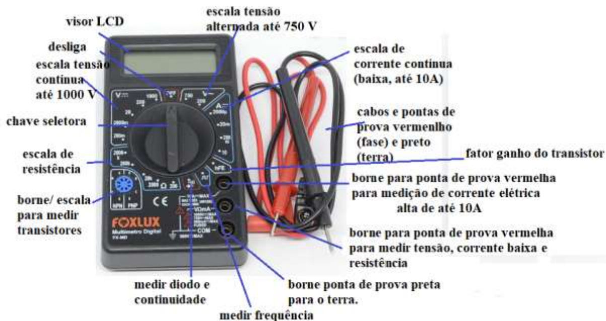
Figura 1. Identificação dos componentes de um multímetro digital.
