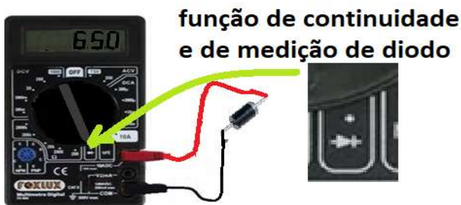
Figura 5 – Multímetro com a chave seletora na função diodo.
