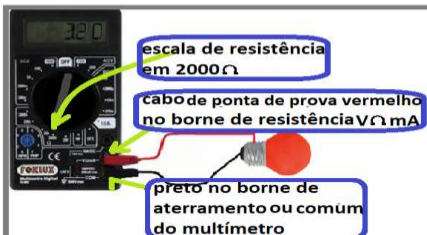
Figura 15: Chave seletora na função ohmímetro e na escala 2000Ω.
