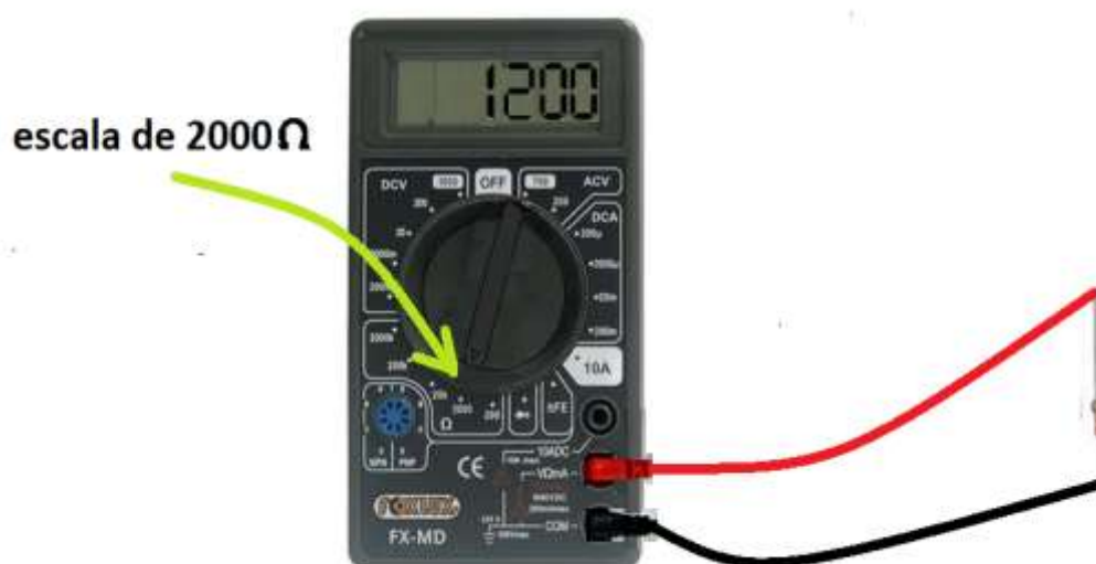
Figura 9 - Medição de resistência em um resistor elétrico.
