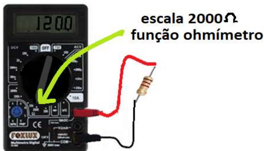
Figura 4 - Multímetro na função ohmímetro para a medição de resistência.
