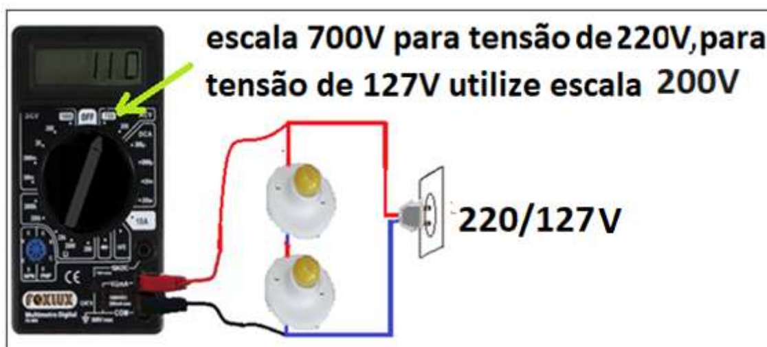
Figura 2 - Multímetro na função voltímetro conectado em paralelo no circuito elétrico.
