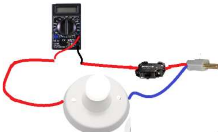
Figura 8: Montagem de um circuito elétrico para medições de corrente alternada da rede elétrica.
