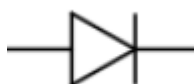
Figura 12: Representação de um diodo para a montagem de um esquema de um dado circuito elétrico.
