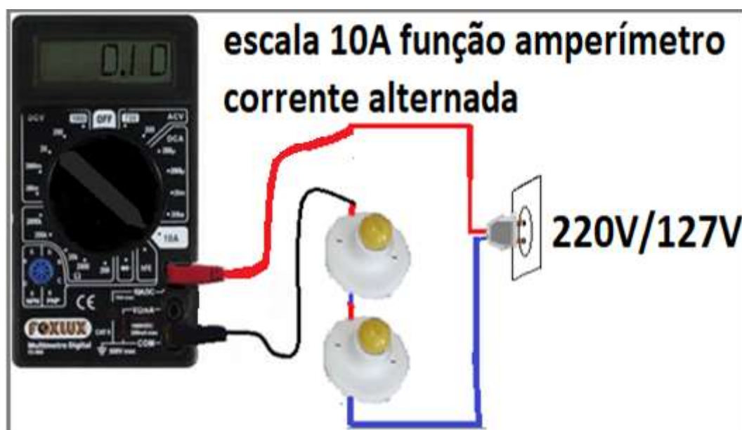
Figura 3 - Multímetro na posição amperímetro.
