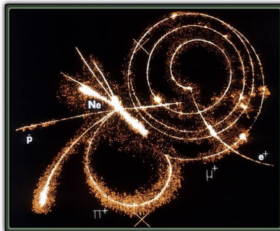
Figura 12 - Imagem da trajetória de vários tipos de partículas, entre elas o Píon positivo.
