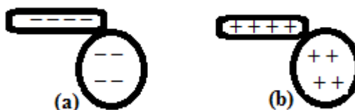
Figura 8 - Eletrização de uma esfera por contato. Em (a) esfera carrega negativamente, em (b) esfera carrega positivamente.
