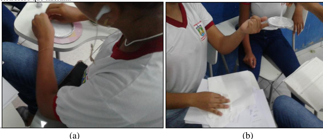
Figura 35 - Oficina para confeccionar o eletróforo. Em (a) aluno monta o aparelho, em (b) alunos testam o eletróforo que fizeram.
