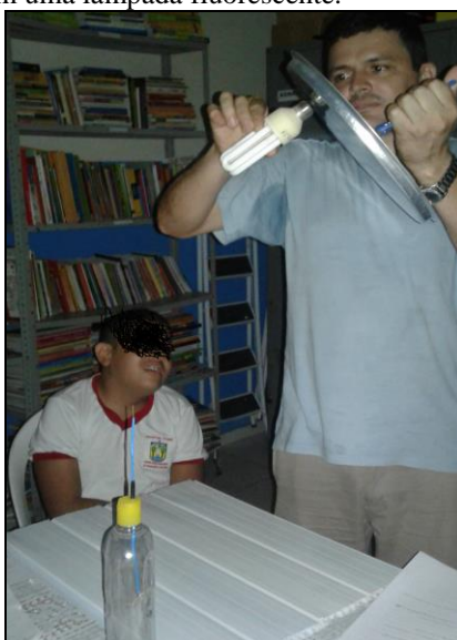
Figura 31 - Descarga do eletróforo em uma lâmpada fluorescente.
