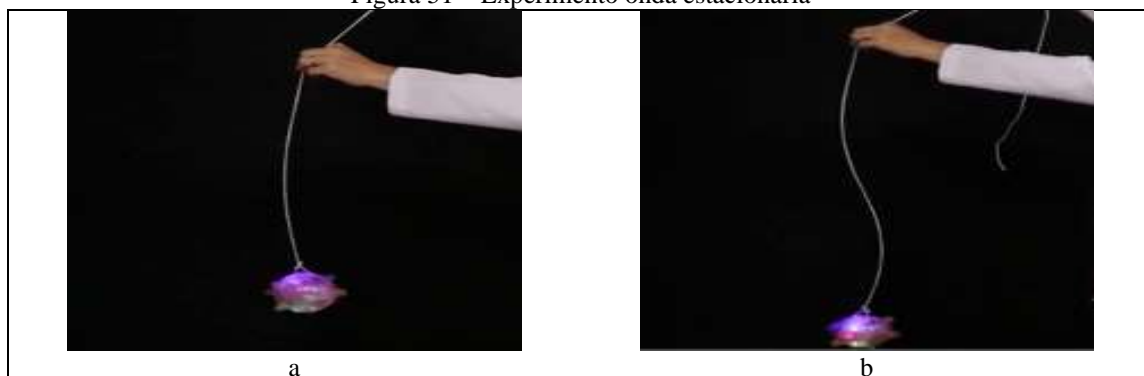
Figura 51 – Experimento onda estacionária
