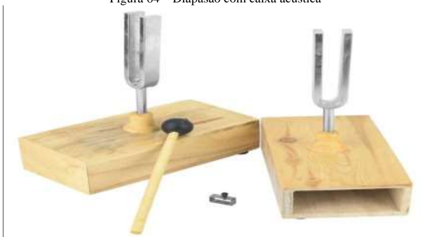
Figura 64 – Diapasão com caixa acústica
